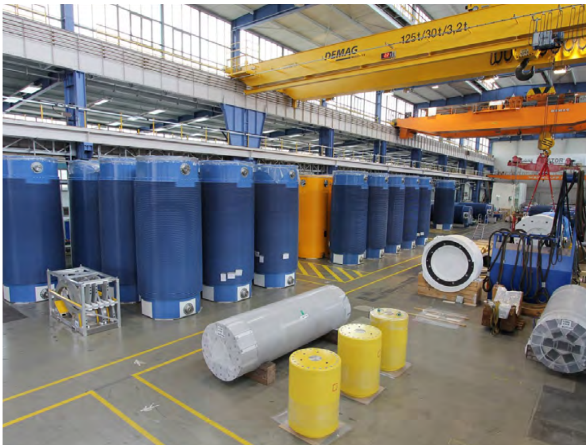
Abb. 10 Betriebsstätte Mülheim innen – CASTOR®-Fertigung. Foto: GNS
