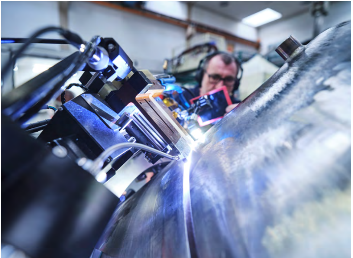
Abb. 4 Engspaltschweißen am Framatome-Standort Erlangen, hier für die Montage eines neuen Dampferzeugers zur Modernisierung eines in Betrieb befindlichen Reaktors. Foto: Framatome GmbH
