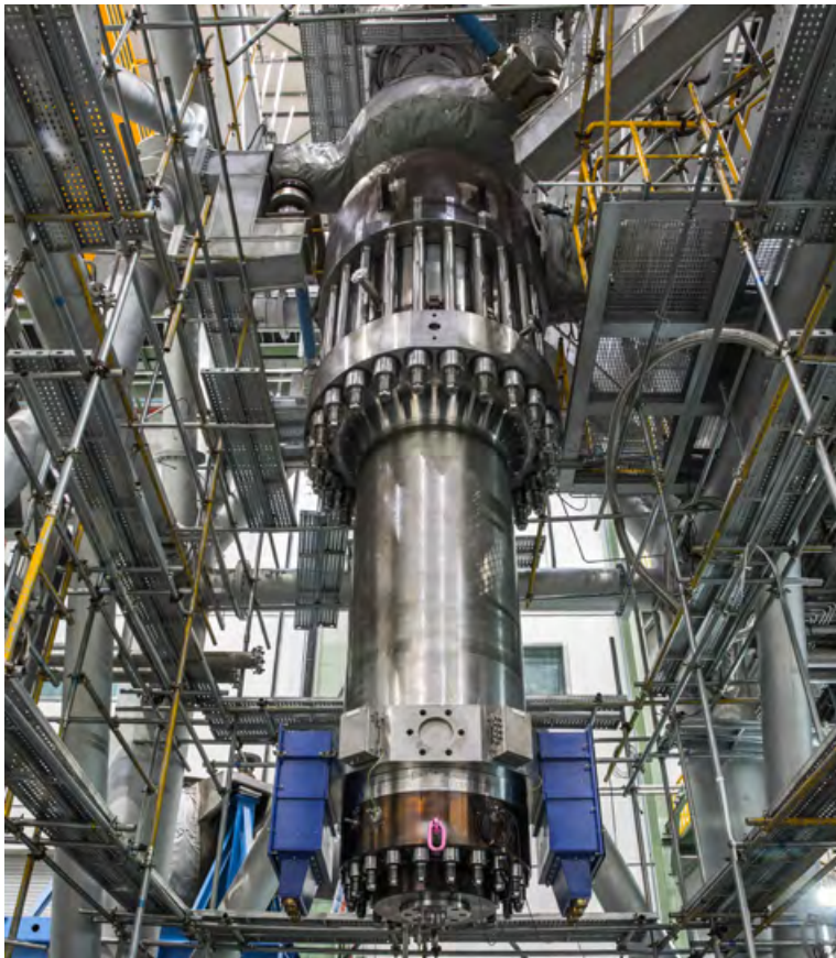
Abb. 6 RUV – Reaktorhauptkühlmittelpumpe für Druckwasserreaktoren der neuesten Generation eingebaut im Leistungsprüfstand. Foto: KSB
