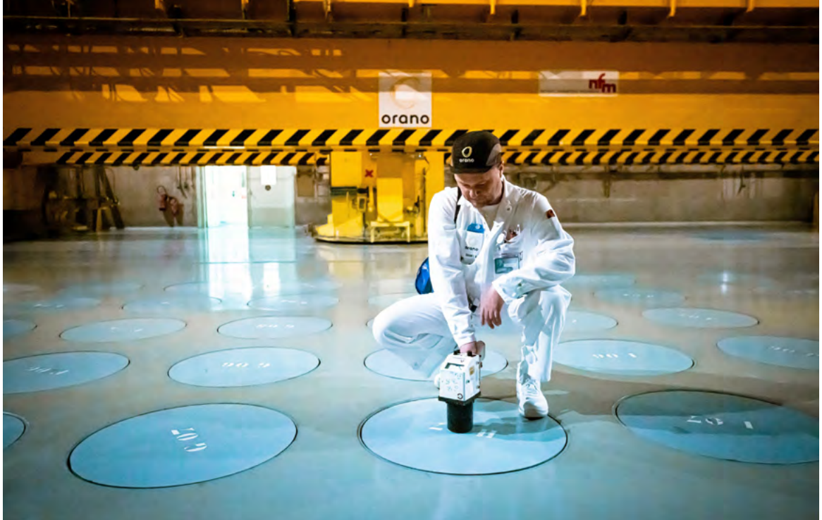
Kontrolle der Dosisleistung, Verglasungsatelier, Wiederaufarbeitungsanlage Orano, Standort La Hague, Beaumont Hague, Frankreich. Foto: Orano
